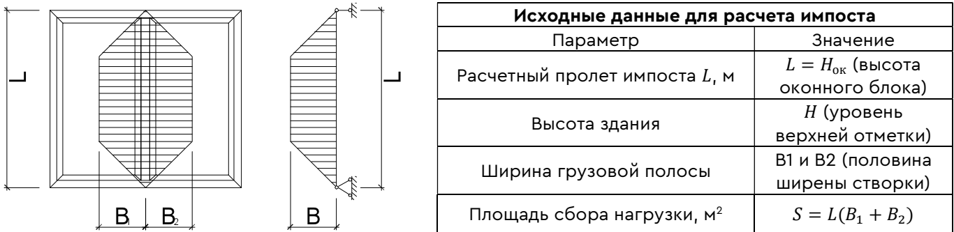
Рис. 12. Расчетная схема определения жесткости оконных блоков под действием равномерно распределенной ветровой нагрузки
